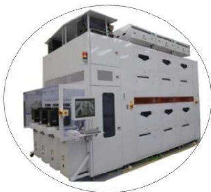
至纯旗下至微科技自主研发 节约高纯硫酸可达80%以上的单片式湿法设备
